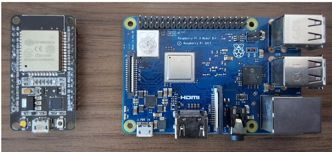
Figura 4.3: Placas ESP32-DevKitC (esquerda) e Raspberry Pi 3B+ (direita)
