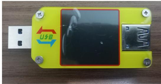
(a) UM34C - Dispositivo de medição de energia via USB
