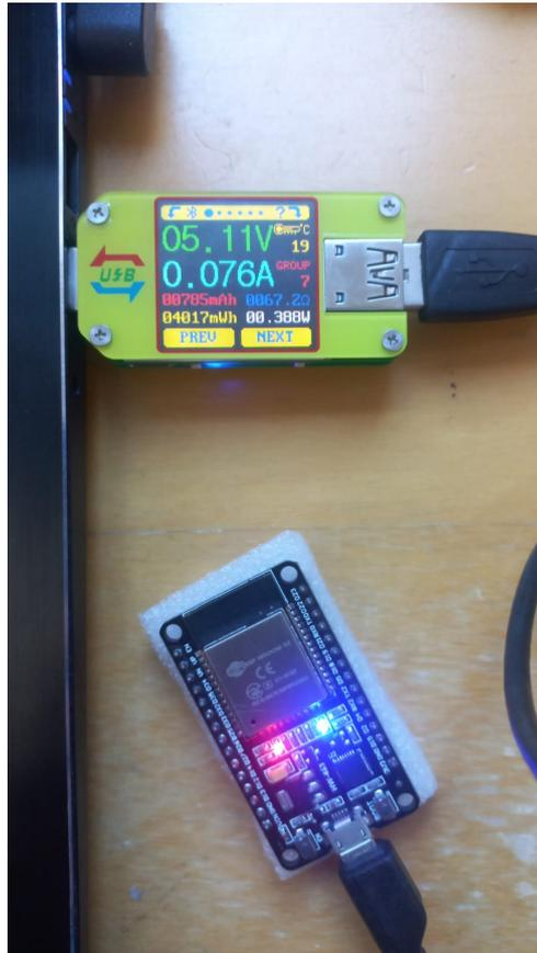
(b) Medição de energia com o ESP32
